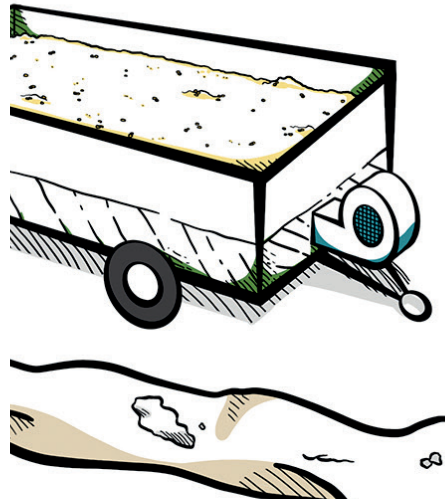
Hackguttrocknung mit doppeltem Boden
